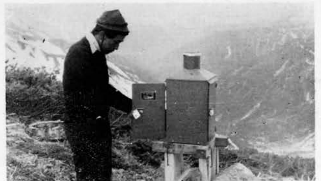
設置を終つて…木台をクイに止め、水平をみてから測器を取付ける。測器の調整をも含め設置には一時間はかかる。(赤嶽にて撮す)
