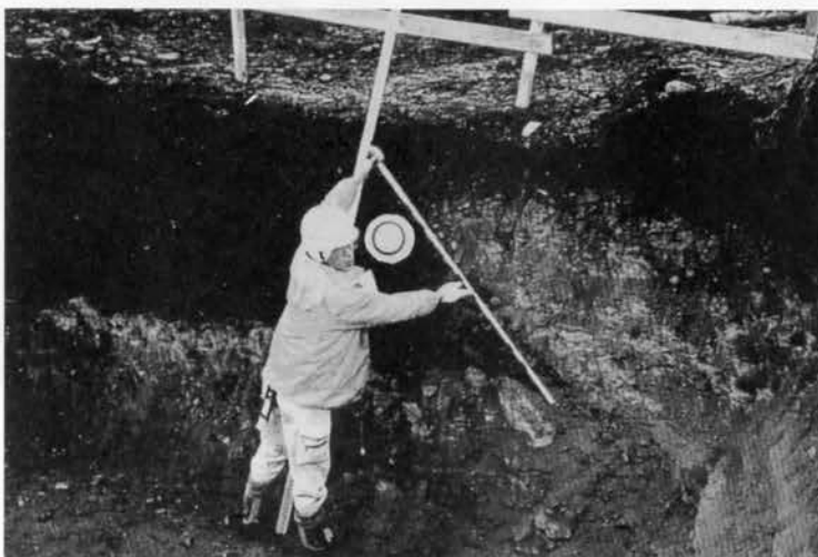
写真2 大町市三日町の活断層発掘 地質調査所1995年11月断 平林照雄 撮影 1995.11.10 白い丸印のところから土器が出たことなどから古墳時代から平安時代の間にできたこととされた
