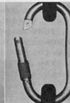
破断後 440kg荷重— (ピンの剪断後)にて開く
