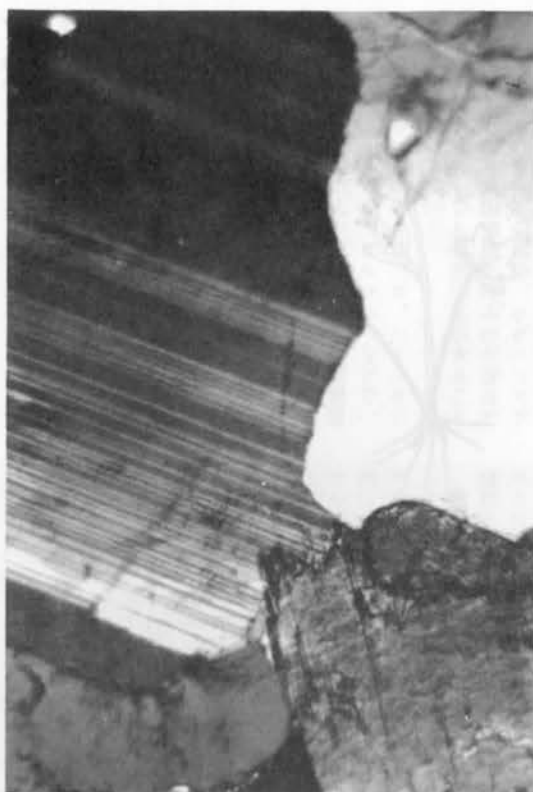
笹平型花崗岩の鉱物顕微鏡写真 右上は石英、右下は黒雲母 左上は斜長石、左下はカリ長石
